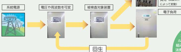
しかし、検査内容によって消費電力にはばらつきがあります。回生による消費電力削減に加え、フライホイール蓄電システムによって消費電力を平準化する取り組みなどを行っています。現在開発中の初号機は、サンケンオプトプロダクツに設置予定です。
