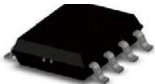
電源効率は今までと大きく変わりますが、従来品は単出力しかなかったものを多出力が可能な回路構成にしました。例えば、顧客が 3 出力を必要とした場合、従来は 3 個の IC が必要でしたが、一つの IC で構成する事が可能になりました。部品数も 1/3 で済み、補助電源全体として省スペース化に大きく貢献しています。
