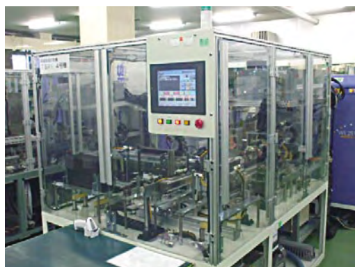
内部の搬送レイアウトを工夫し小型化したIC検査装置
